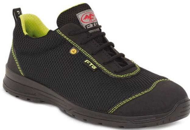
Calzatura bassa in mesh nero con imbottitura al malleolo, fodera 100% poliestere, sottopiede non metallico HRP, soletta SPORT-LITE anatomica e antistatica, suola in poliuretano bidensità resistente alle flessioni e alle abrasioni, antiolio, antiscivolo, antistatica. Calzatura super leggera realizzata con il minor quantitativo possibile di materiale e i minimi spessori consentiti dalle norme vigenti. Il massimo livello di sicurezza unito al più alto grado di leggerezza mai raggiunto.
